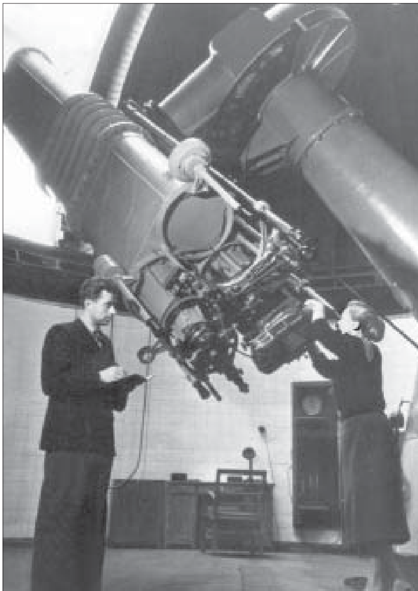
А.Б. Онсгіна та І.В. Гаврилов перевіряють юстування касетної частини подвійного довгофокусного астрографа
