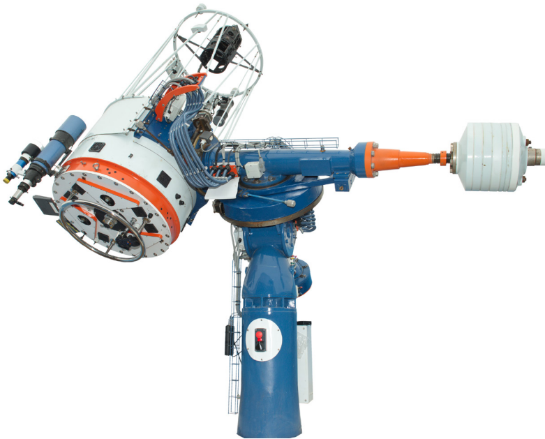
Рис. 9.9. Автоматизований телескоп з діаметром головного дзеркала 0,8 м, встановлений на одній із спостережних станцій Астрономічної обсерваторії Одеського національного університету
