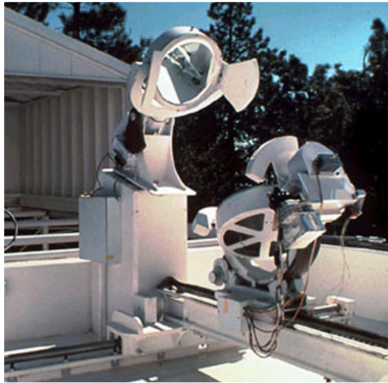
Рис. 9.10. Целостат сонячного телескопа
