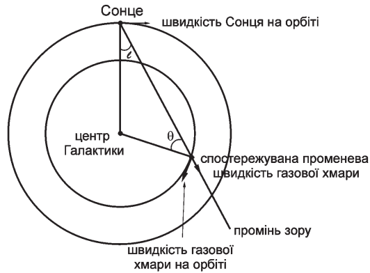
Рис. 21.10. До визначення відстаней і швидкостей газових хмар за спостереженнями нейтрального Гідрогену на довжині хвилі 21 см
