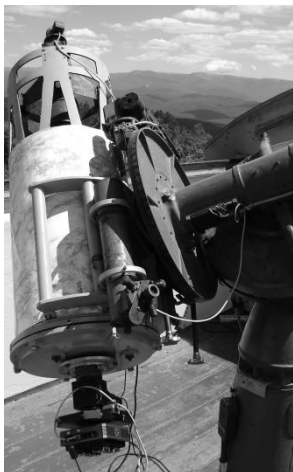
Рис. 15. Телескоп К-380 системи Кассегрена діаметром 38 см (КраО)
