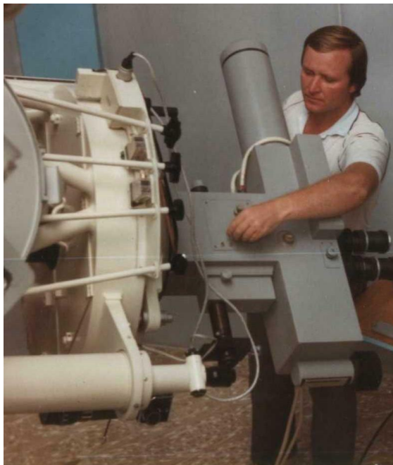
Рис. 2. Спектрополяриметр «Планетний патруль» на 60-см телескопі в обсерваторії Санта Анна (Болівія).
