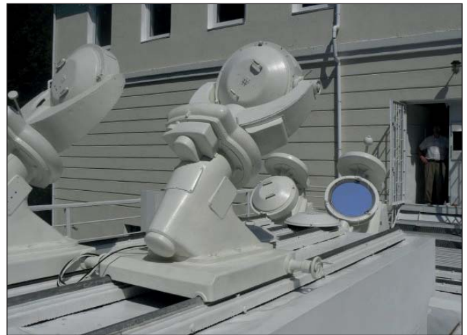
Горизонтальний сонячний телескоп АЦУ-5 імені Ернеста Гуртовенка
