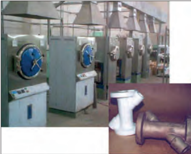
Рис. 2. Загальний вигляд модельного цеху з рядом автоклавів для спікання моделей з ППС та різні виливки у галузі моторобудування
