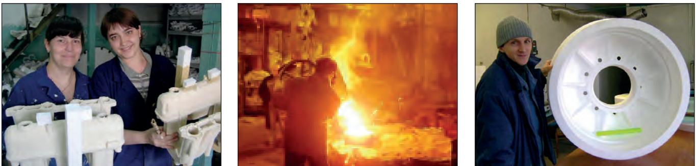
Рис. 5. Моделі колектора двигуна; заливка металом ливарних форм; модель катка
