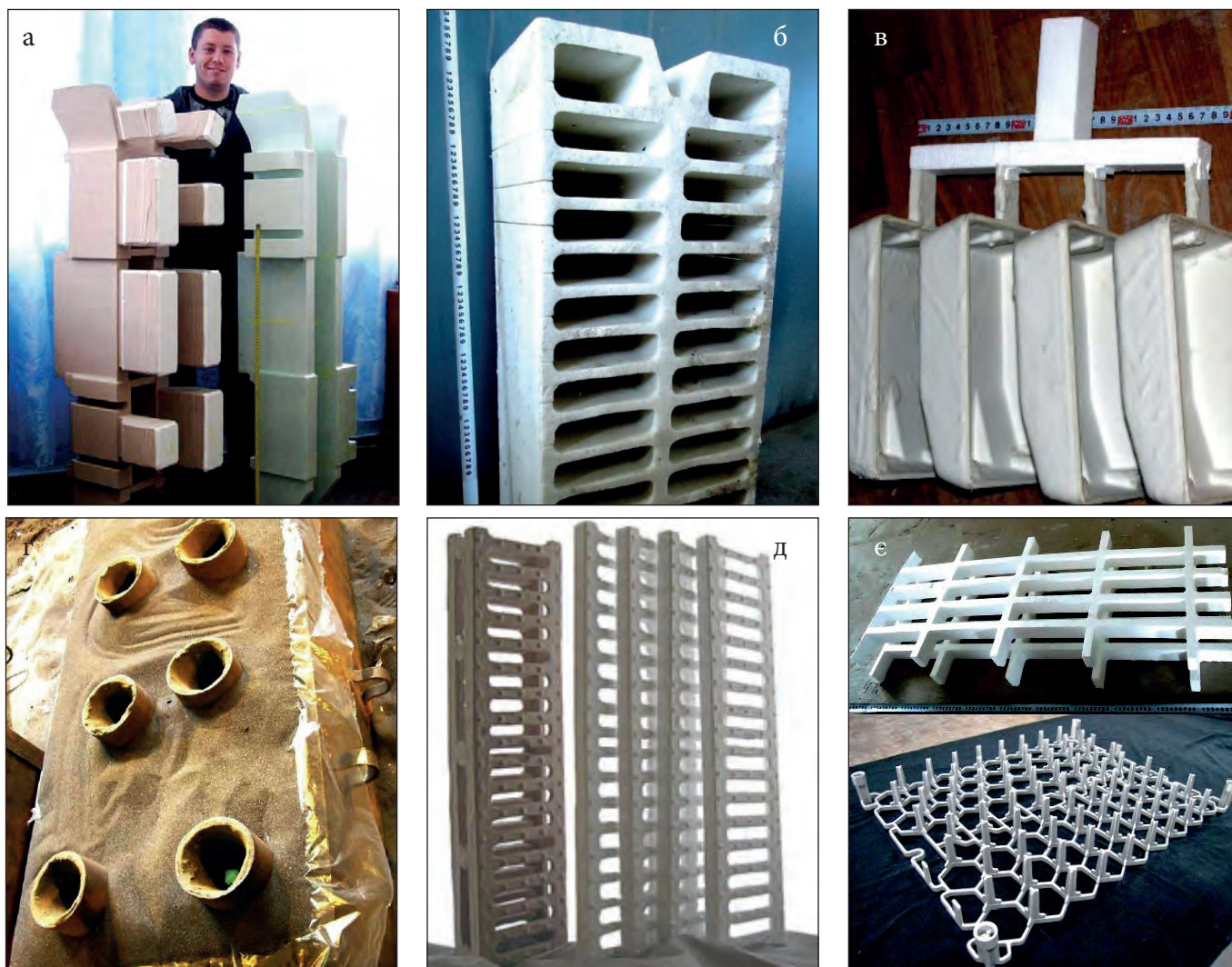
Рис. 8. Приклади моделей і форм для ЛГМ: а, б - великі складені з частин моделі; в - куц моделей; г - традиційна контейнерна форма з шістьма модельними куцями і ливниковими воронками; д, е - деталі моделей для складання довгомірних ґратчастих конструкцій
