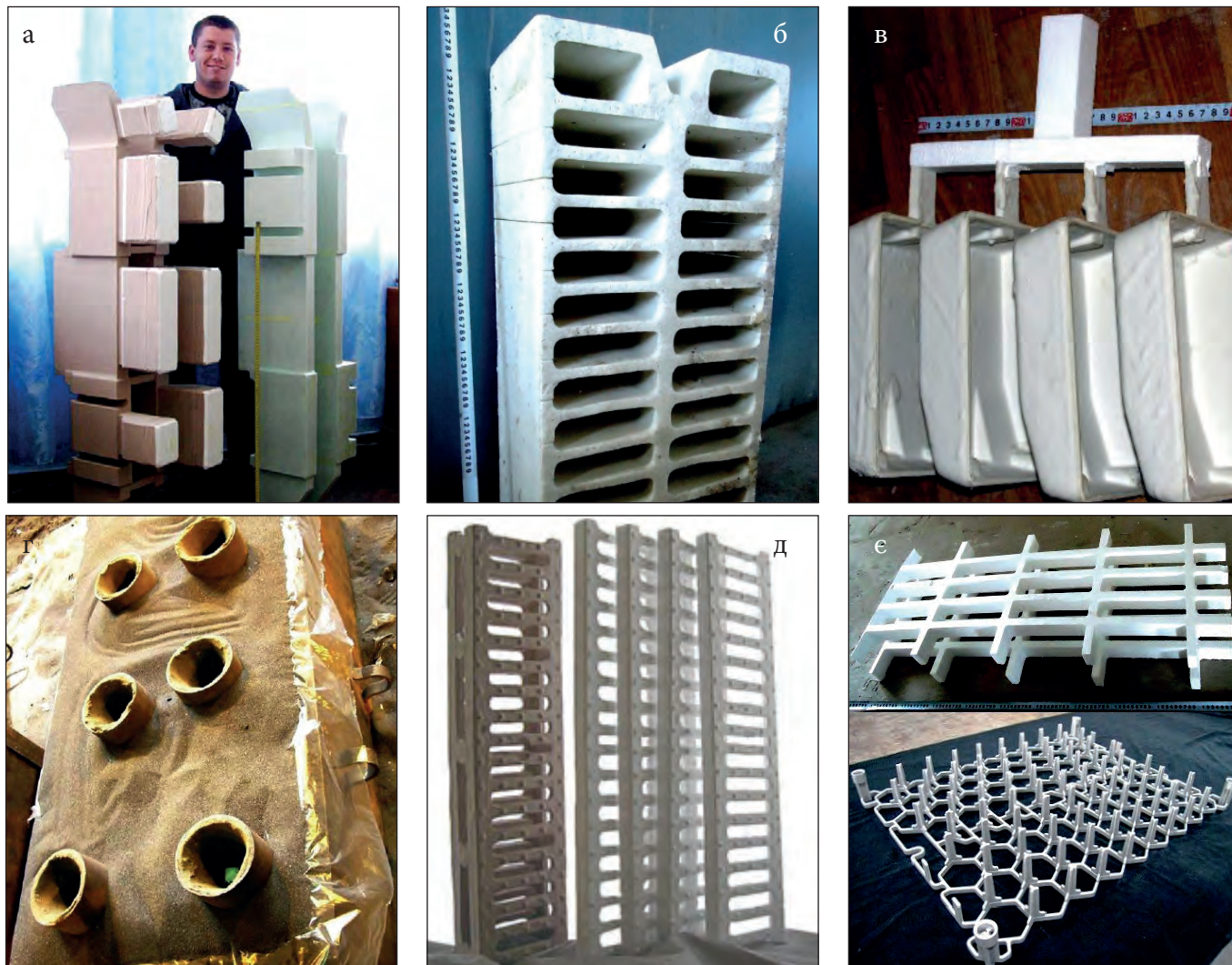
Рис. 8. Приклади моделей і форм для ЛГМ: а, б - великі складені з частин моделі; в - куц моделей; г - традиційна контейнерна форма з шістьма модельними куццями і ливниковими воронками; д, е - деталі моделей для складання довгомірних ґратчастих конструкцій
