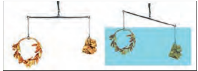
Рис. 30. Зважування корони у повітрі та у воді
