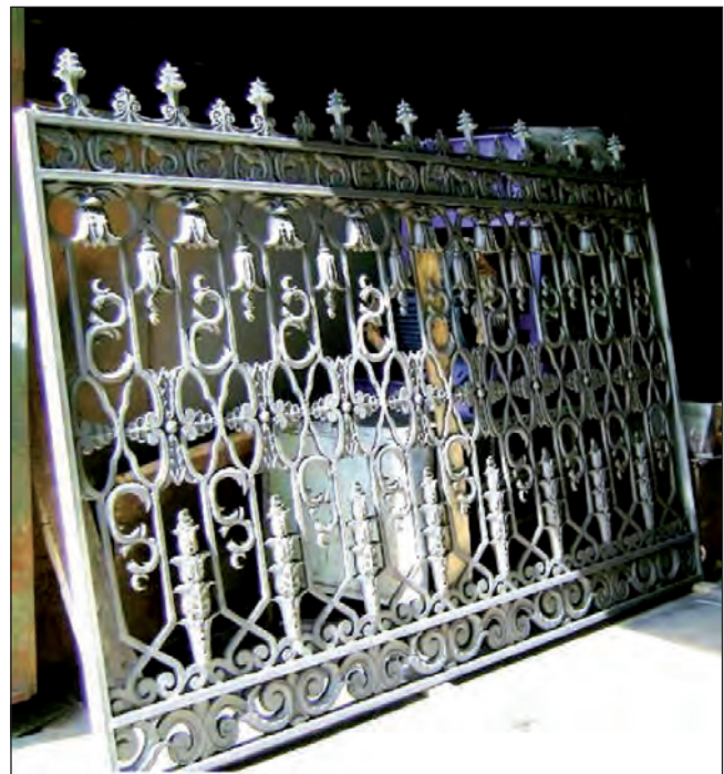
Рис. 9. Крупні моделі виливків декоративних решіток огорож, а також лава, яка показана поруч з моделлю
