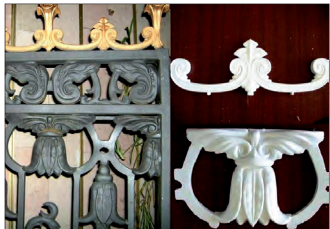
Рис. 10. Крупна лито-зварна секція декоративної огорожі з вуглецевої сталі в цеху ФТІМС НАН України, а також її фрагмент з моделями деталей, які її складають
