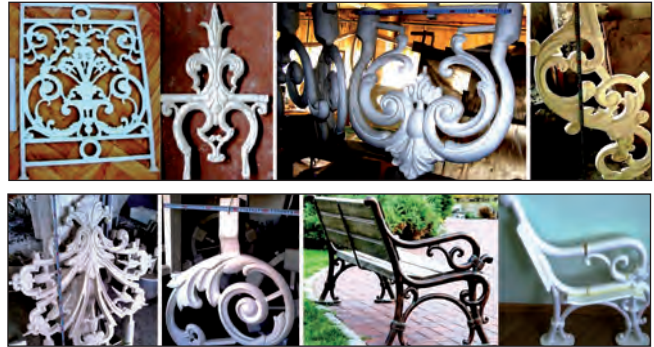
Рис. 9. Крупні моделі виливків декоративних решіток огорож, а також лава, яка показана поруч з моделлю
