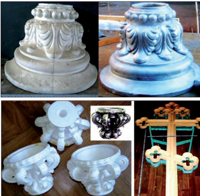
Рис. 13. Модель і пустотілий алюмінієвий виливок підставки під колону, 3 моделі і виливок підставки під плафон вуличного світильника
