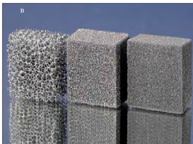
Рис. 1. Приклади розробок німецьких учених [2]: а — пінополіуретанова піна з наскрізними порами (збільшено, розмір комірки до 2,5 мм) (рисунок розміщений на попередній стор. 57); б — трубчасті теплообмінники зі сталеву піною (сталь 316L, комірка шириною 20 мкм); в — зразки литої піни з нержавіючої сталі 316L (розмір комірки 20, 45 і 60 мкм)
