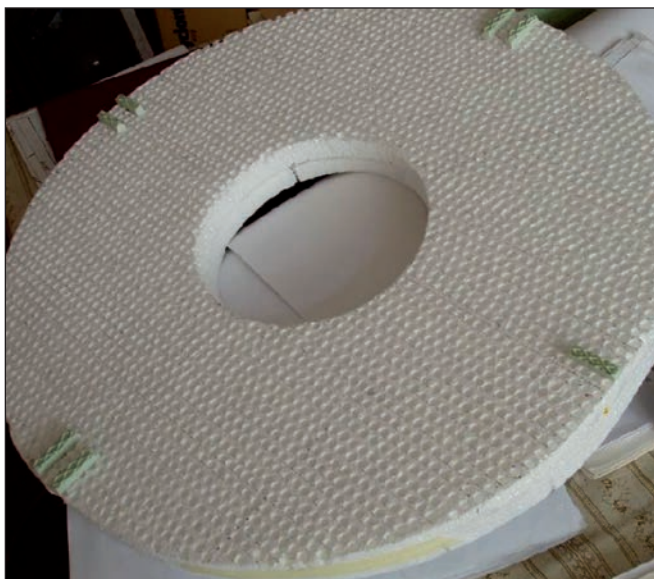
Рис. 7. Модель деталі колосника печі
