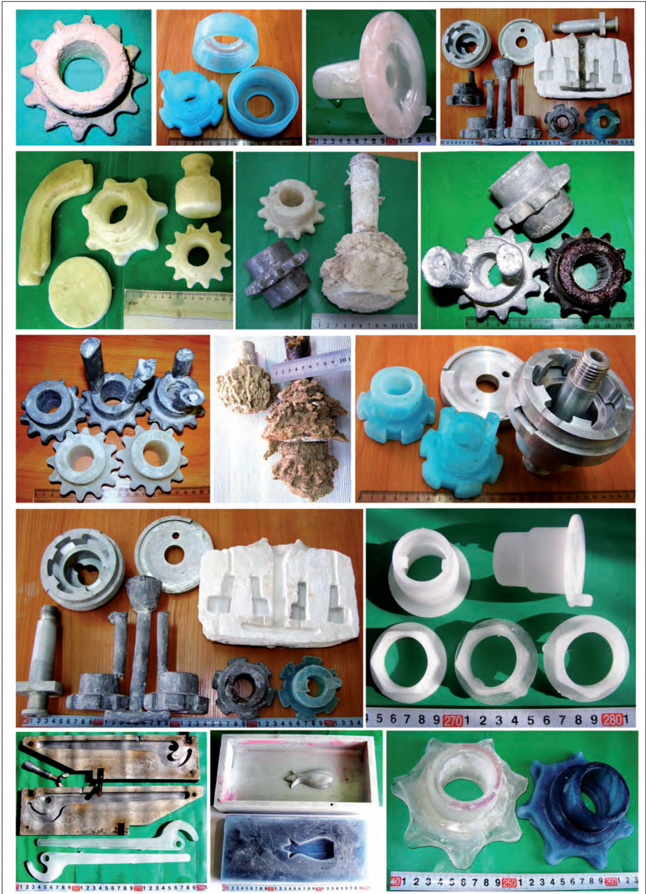
Рис. 2, а. Фотографії льдяних моделей, прес-форм для їхнього отримання, оболонкових форм і виливків, розроблених у Фізикотехнологічному інституті металів і сплавів НАН України
