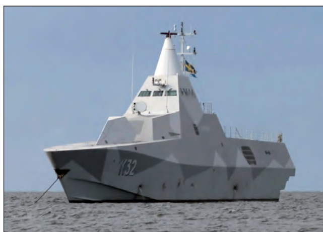
Рис. 7. Стелс-технології: американський літак-бомбардувальник В-2 і шведський корвет К32 НМС
