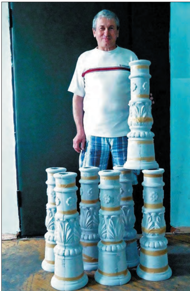
Рис. 1. Приклади виготовлення моделей для ЛГМ на 3D-фрезерах
