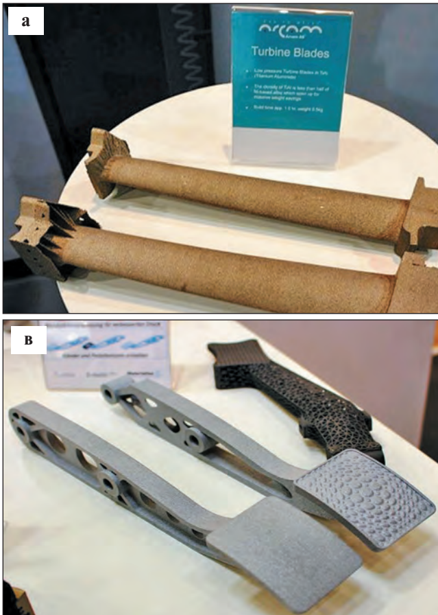
Рис. 6. Приклади 3D-технологій для виробництва металевих виробів: а — деталь бурового насоса для нафти і газу, що виготовлена з матеріалу BLDRmetal™ J-10 [6]; б — лопатки турбіни; в — педалі; г — процес 3D-сканування поверхні виливки турбіни (зображення (а–в) взяті з репортажів про виставки Euroform-2015 і Formnext-2015)
