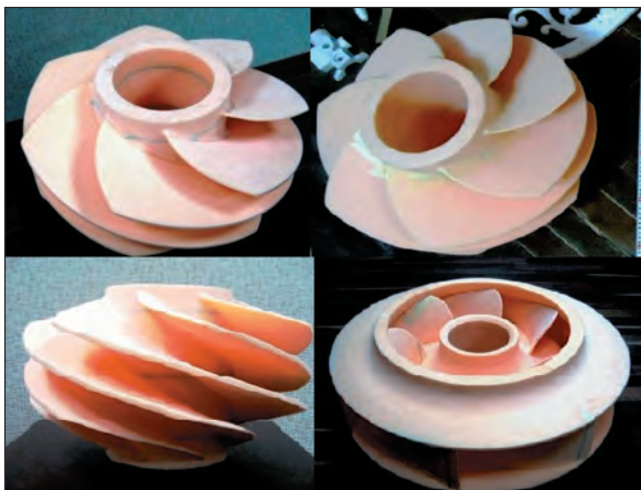
Рис. 1. Приклади виготовлення моделей для ЛГМ на 3D-фрезерах
