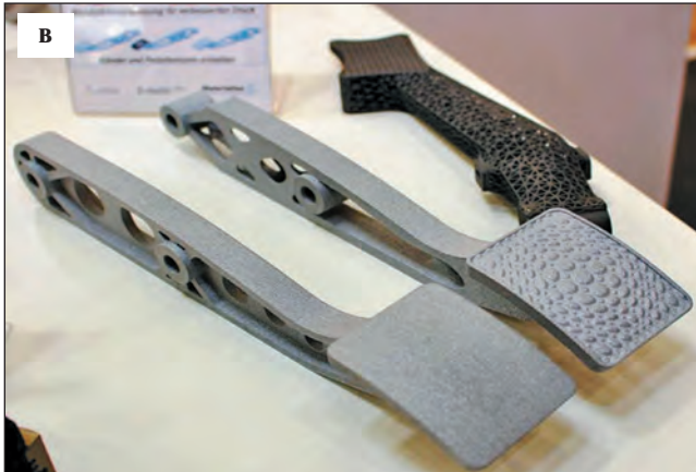
Рис. 6. Приклади 3D-технологій для виробництва металевих виробів: а — деталь бурового насоса для нафти і газу, що виготовлена з матеріалу BLDRmetal™ J-10 [6]; б — лопатки турбіни; в — педалі; г — процес 3D-сканування поверхні виливки турбіни (зображення (а–в) взяті з репортажів про виставки Euroform-2015 і Formnext-2015)
