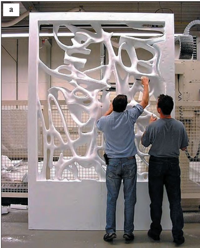
Рис. 2. Художнє литво — архітектурна прикраса житлового будинку: а — модель воріт; б — секції алюмінієвих виливків колажу, зібраного вздовж великої будівлі Нью-Йорка [4]
