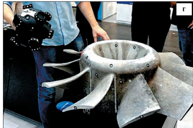
Рис. 6. Приклади 3D-технологій для виробництва металевих виробів: а — деталь бурового насоса для нафти і газу, що виготовлена з матеріалу BLDRmetal™ J-10 [6]; б — лопатки турбіни; в — педалі; г — процес 3D-сканування поверхні виливки турбіни (зображення (а–в) взяті з репортажів про виставки Euroform-2015 і Formnext-2015)
