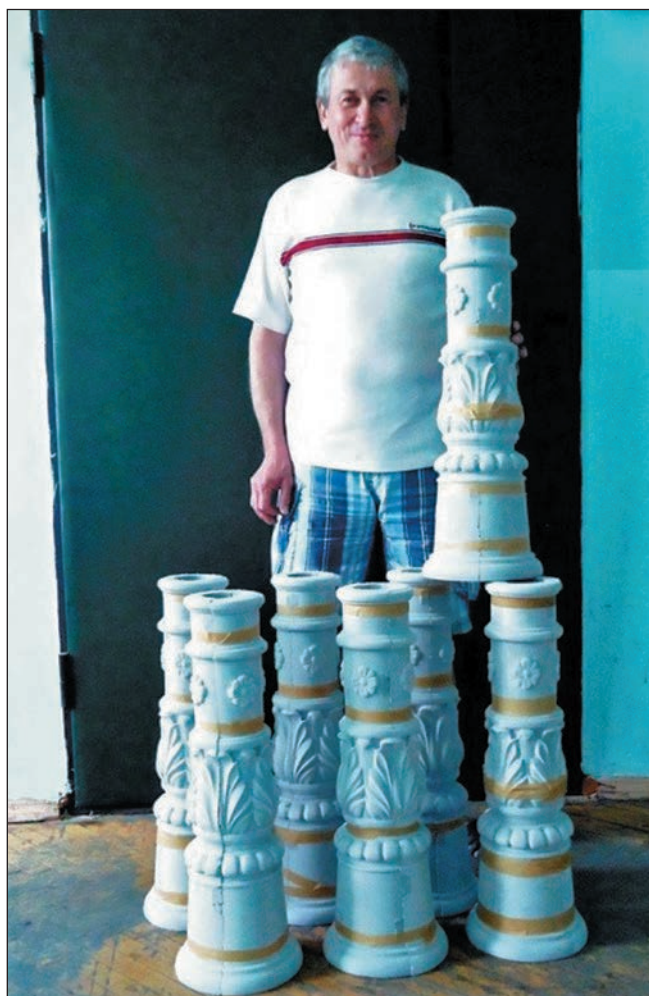
Рис. 1. Приклади виготовлення моделей для ЛГМ на 3D-фрезерах
