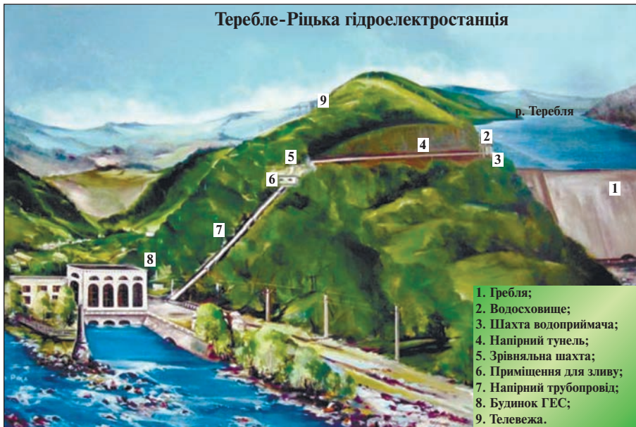
Рис. 1. Схема Терєбле-Ріцької ГЕС і Вільшанського водосховища ( http://kolochava.com/ua/ ).
