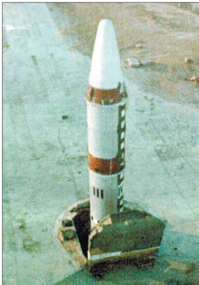
Класика бойового ракетобудування: мінометний старт МБР Р-36М зі шахтної пускової установки (SS-18 Satan Mod 1)
