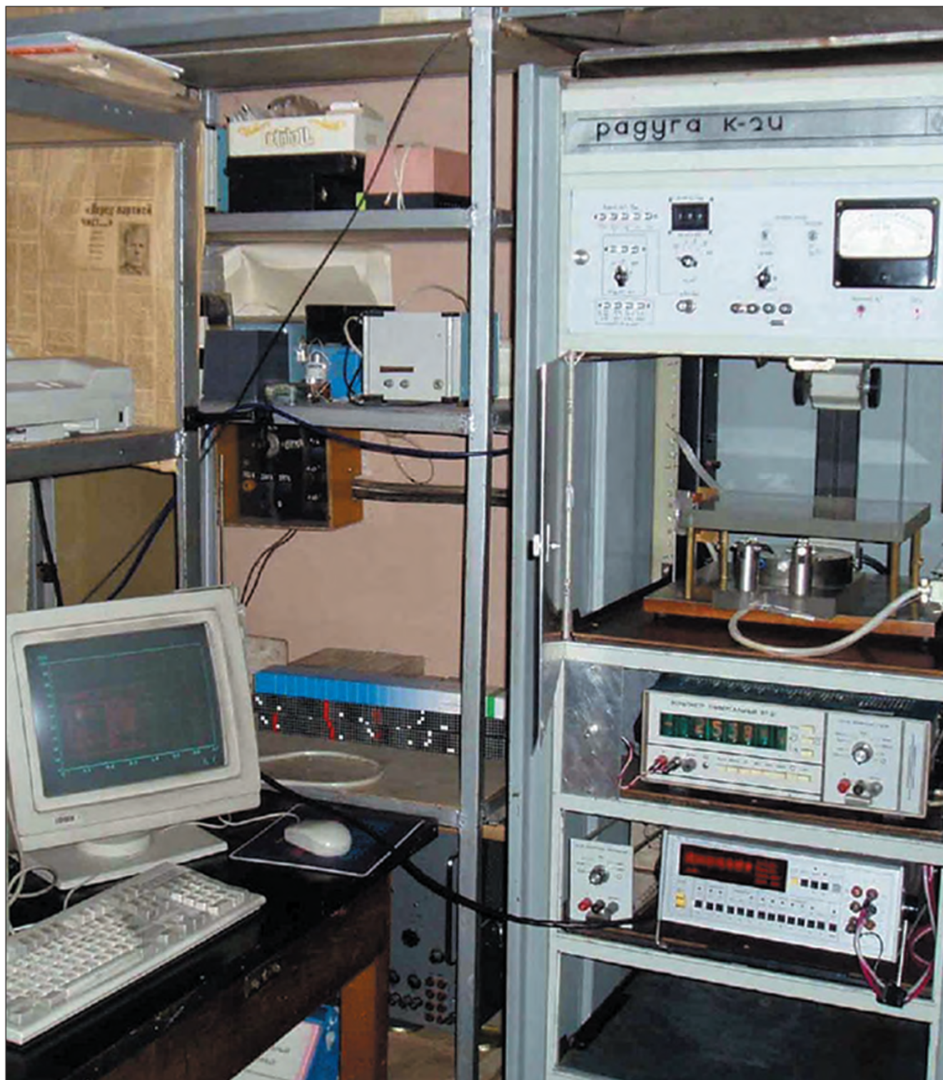
Рис. 10. Стендова база Центру випробувань фотоперетворювачів та фотоелектричних батарей Інституту фізики напівпровідників ім. В.Є. Лашкарьова НАН України. Випробування фотоенергетичних параметрів дослідного зразка фотоелектричної батареї для космічного апарата КСМФ2 “Мікрон”
