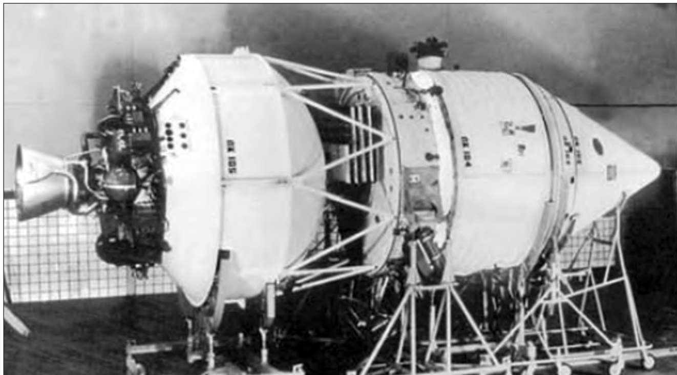
Пілотований корабель ЛК-1 для обльоту Місяця з використанням РН "Протон". Проект 1964 року
