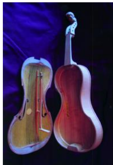
Класична пружина (зверху) і пружина Ф. Юр'єва (знизу)
