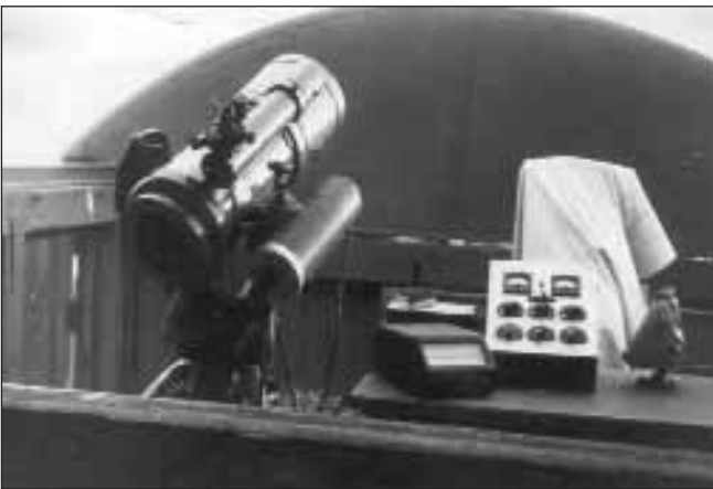
Рис. 6. Перший у КраО електрофотометр, установлений на телескопі МТМ-200. На столі розміщений прилад для вимірювання струму (гальванометр) і підсилювач з ручками керування
