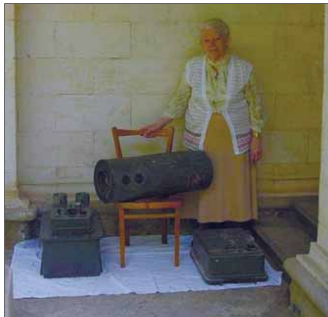
Рис. 8. Апаратура, яку використовували у випробуваннях 6-камерного ЕОП. Ліворуч — високовольтний блок живлення каскадів ЕОП, у центрі — соленоїд, у якому розміщувався ЕОП, праворуч — блок живлення котушок соленоїда. Стоїть — учасниця досліджень, професор Валентина Прокоф'єва-Михайловська
