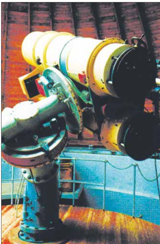
Рис. 6. 40-см подвійний астрограф КрАО — телескоп, на якому Кримська група малих планет відкрила 1286 нових астероїдів і 2 комети
