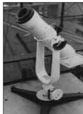
Рис. 5. Трубка АТ-1, створена для спостереження першого ШСЗ
