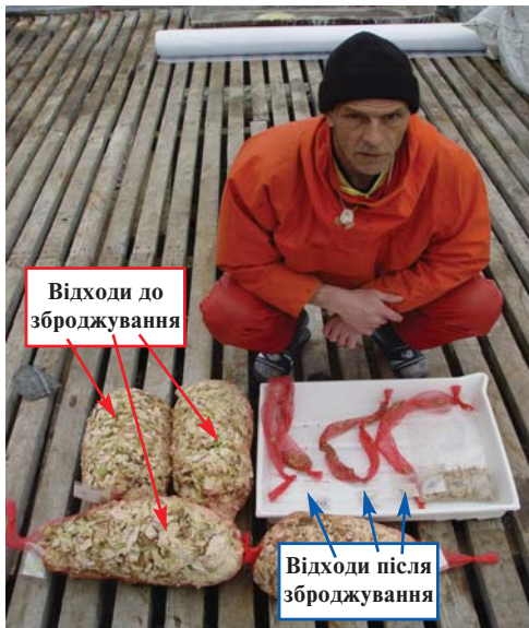
Рис. 13. Ефективність мікробної технології переробки твердих харчових відходів на станції «Академік Вернадський» 1 — відходи (капустяні стрижні) до зброджування; 2 — відходи після 7 діб ферментації
