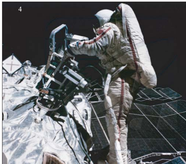
Льотчики-космонавти СРСР С. Савицька (рис. 4) і В. Джанібєков (рис. 5) під час виконання експериментів з космічного зварювання у відкритому космосі на борту ОКС "Салют-7". 25 липня 1984 р.
