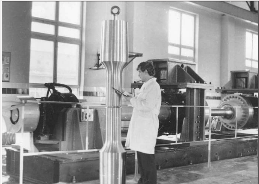
Розроблена під керівництвом Г.В.Карпенка унікальна машина УФМІ-200 для дослідження впливу середовища на втому матеріалів великогабаритних конструкцій. На передньому плані — оператор готує зразок до випробування
