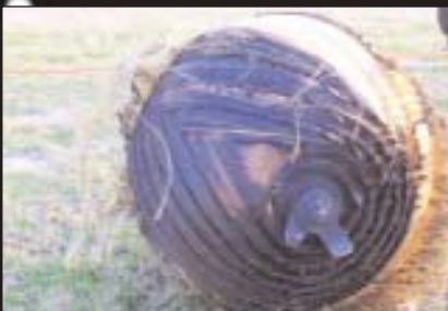
Уламки двигуна 3-го ступеня РН "Delta" (Саудівська Аравія, 2001 р.)
