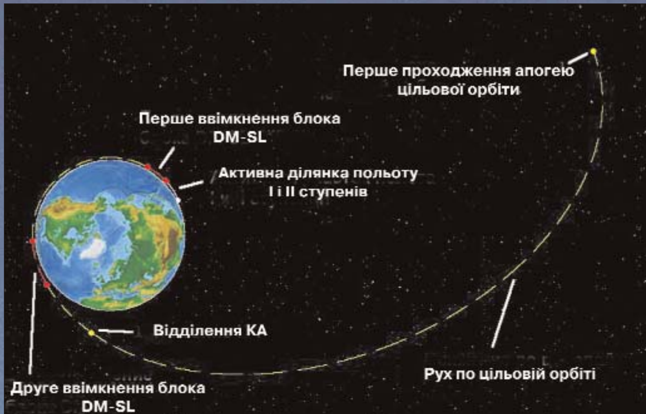
Схема виведення КА ракетою-носієм "Зеніт-3SL" за програмою "Морський старт"
