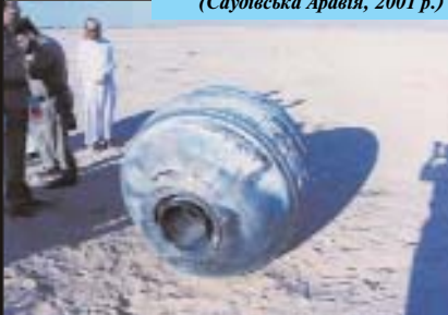
Уламки двигуна 3-го ступеня РН "Delta" (Саудівська Аравія, 2001 р.)
