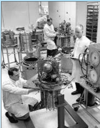
Рис. 2. Складання гідразинових паливних елементів
