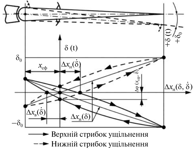
Рис. 1. Залежності \Delta x_{\text{в}}(\delta, \dot{\delta}) = f(\delta) та \Delta x_{\text{н}}(\delta, \dot{\delta}) = f(\delta) при x_{\text{с}} = x_{\text{сф}} , \delta_0 = 0.25\phi_0
