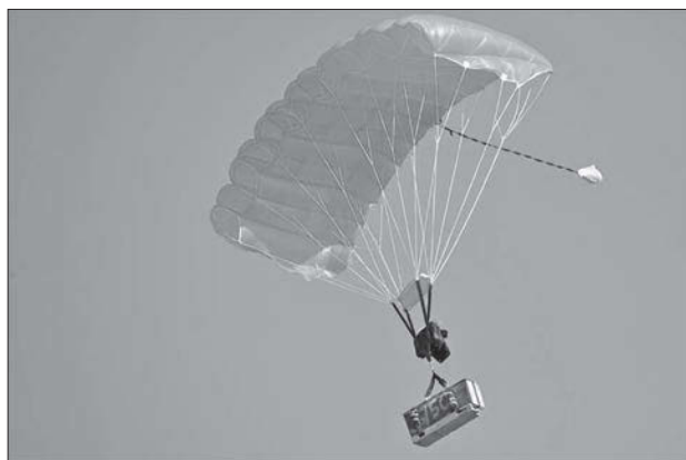
Рис. 6. Система Onyx ML з імітацією корисного навантаження максимальною масою (70 кг) [30]
