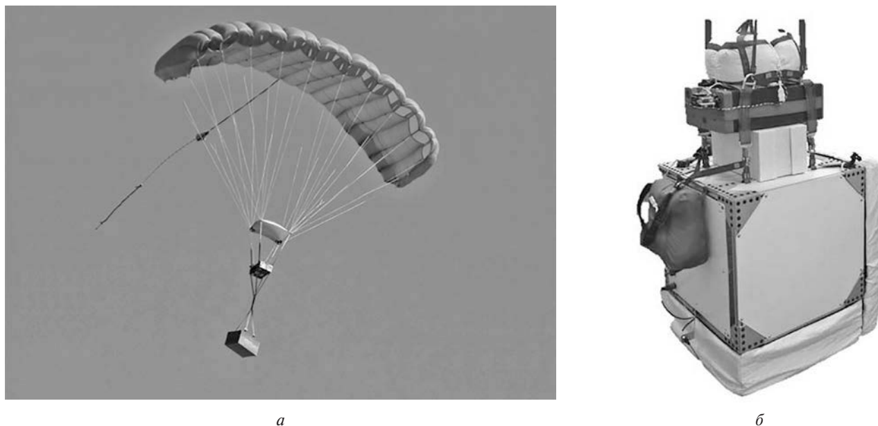
Рис. 4. Керована висотна система десантування (GP-HAR) [10]: а — розкрита керована висотна система десантування, б — зібрана керована висотна система десантування
