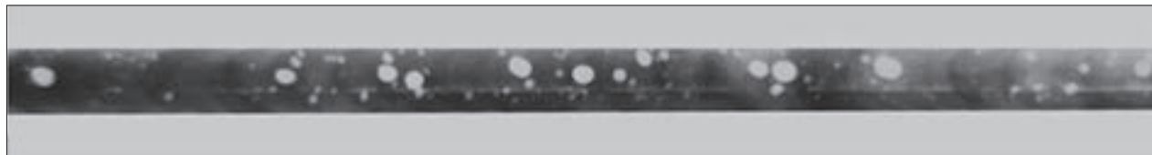
Рис. 1. Рентгенограма стикового з'єднання сплаву АМг6, отриманого електронно-променевим зварюванням на літаційній лабораторії в режимі зниженої гравітації (1/6g (поверхня Місяця))
