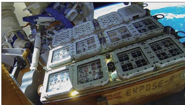
Рис. 1. Експериментальна система EXPOSE-R2 із BIOMEX на борту МКС. DLR Інститут аерокосмічної медицини
