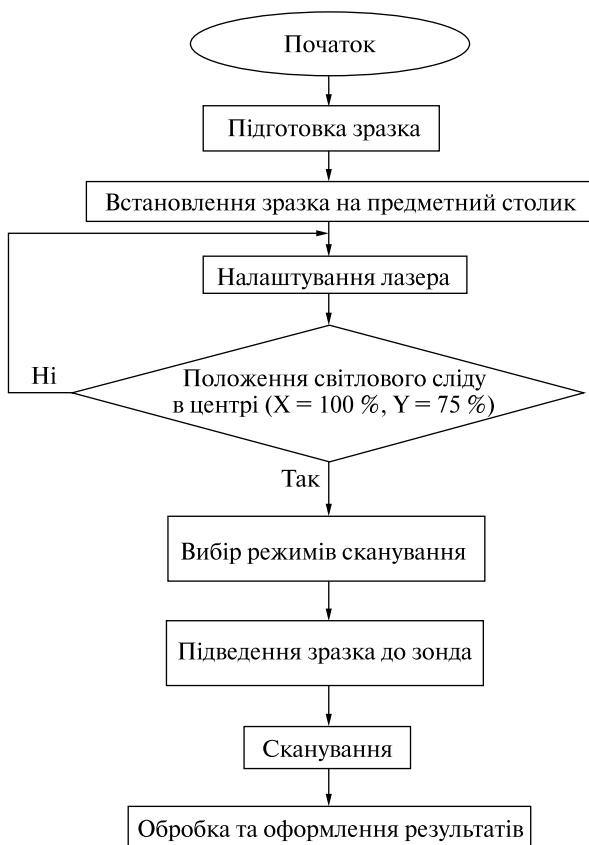
Рис. 1. Алгоритм проведення дослідження поверхонь за допомогою АСМ
