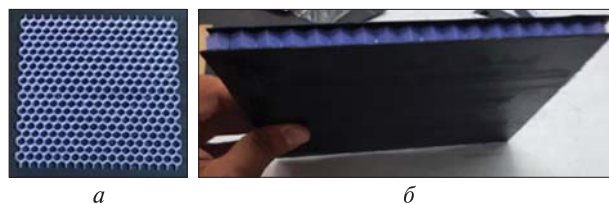
Рис. 8. Склеювання тришарових пластин (а — стільниковий заповнювач із приклеєною однією стороною, б — тришарова пластинка)
