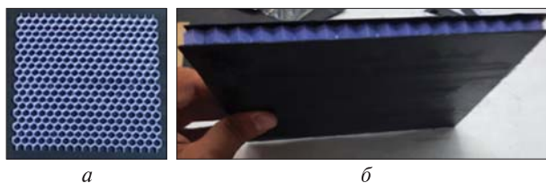
Рис. 8. Склеювання тришарових пластин (а — стільниковий заповнювач із приклеєною однією стороною, б — тришарова пластина)
