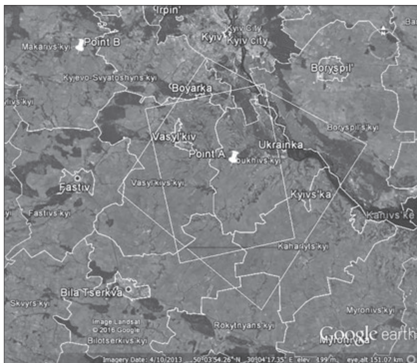
Рис. 4. Схема розміщення станцій Київської метеорної групи. Поле зору в п. А спрямовано в зеніт і не орієнтувалося по азимуту, зріз полів зору відповідає висоті 100 км
