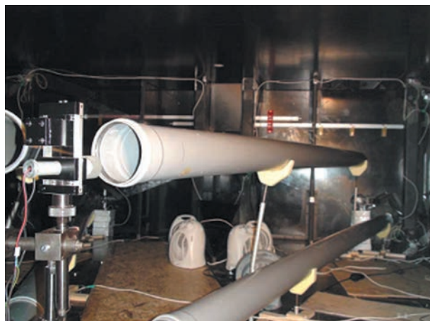
Рис. 7. Трубы, внутри которых распространялись лазерные лучи
