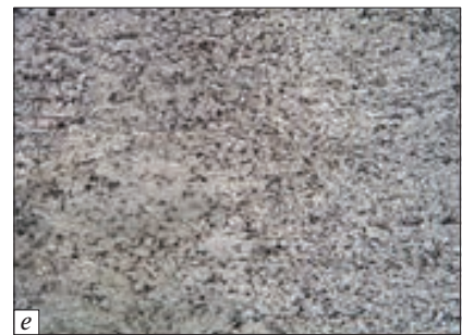
Рис. 8. Мікроструктури трубчастих стикових з'єднань із сталі 12X18H10T ( а, б, в ) та сплаву ВТ1-0 ( г, д, е ), одержаних аргонно-дуговим зварюванням: а, г — центральні ділянки металу шва; б, д — ділянки швів другого проходу; в — ділянка кордону лінії сплавлення та зони термічного впливу, е — ділянка зони термічного впливу і основного металу
