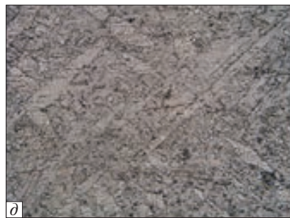
Рис. 8. Мікроструктури трубчастих стикових з'єднань із сталі 12X18H10T ( а, б, в ) та сплаву ВТ1-0 ( г, д, е ), одержаних аргонно-дуговим зварюванням: а, г — центральні ділянки металу шва; б, д — ділянки швів другого проходу; в — ділянка кордону лінії сплавлення та зони термічного впливу, е — ділянка зони термічного впливу і основного металу
