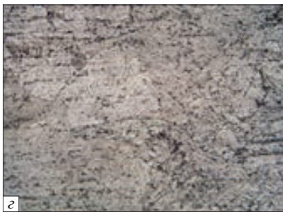
Рис. 8. Мікроструктури трубчастих стикових з'єднань із сталі 12X18H10T ( а, б, в ) та сплаву ВТ1-0 ( г, д, е ), одержаних аргонно-дуговим зварюванням: а, г — центральні ділянки металу шва; б, д — ділянки швів другого проходу; в — ділянка кордону лінії сплавлення та зони термічного впливу, е — ділянка зони термічного впливу і основного металу
