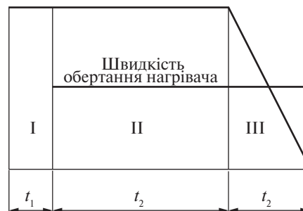
Рис. 4. Характер зміни технологічних параметрів зварювального циклу при орбітальному електронно-променевому зварюванні труб: I — «гарячий старт», t_1 = 0...5 с; II — час зварювання, t_2 = 30 с; III — виведення кратера, t_3 = 0...5 с
