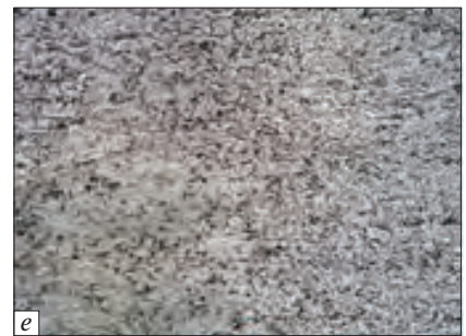
Рис. 8. Мікроструктури трубчастих стикових з'єднань із сталі 12X18H10T ( a, б, в ) та сплаву BT1-0 ( г, д, е ), одержаних аргонно-дуговим зварюванням: a, г — центральні ділянки металу шва; б, д — ділянки швів другого проходу; в — ділянка кордону лінії сплавлення та зони термічного впливу, е — ділянка зони термічного впливу і основного металу
