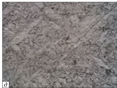
Рис. 8. Мікроструктури трубчастих стикових з'єднань із сталі 12X18H10T ( a, б, в ) та сплаву BT1-0 ( г, д, е ), одержаних аргонно-дуговим зварюванням: a, г — центральні ділянки металу шва; б, д — ділянки швів другого проходу; в — ділянка кордону лінії сплавлення та зони термічного впливу, е — ділянка зони термічного впливу і основного металу
