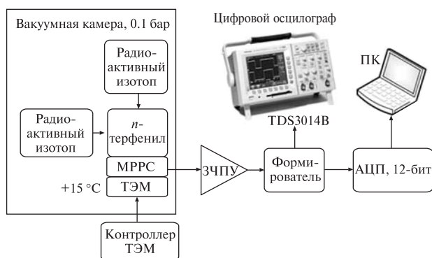
Рис. 2. Блок-схема лабораторного стенда для исследования спектрометрических характеристик малогабаритных органических сцинтилляторов
