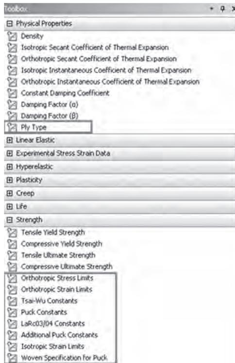
Рис. 4. Свойства материалов для использования (ANSYS Composite PrepPost User's Guide)
