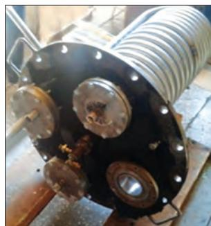
Рис. 3. Внешний вид теплообменника, смонтированного на крышке ёмкости
