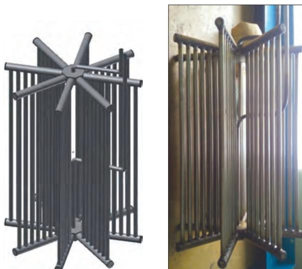
Рис. 7. 3D-модель теплообменника пакетного типа
