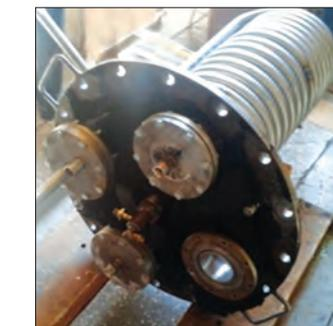
Рис. 3. Внешний вид теплообменника, смонтированного на крышке ёмкости
