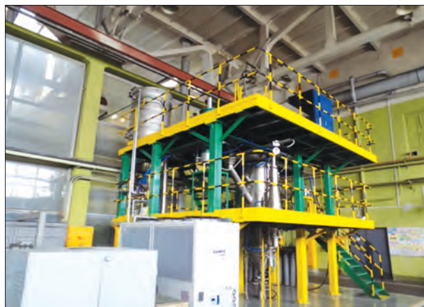
Рис. 6. Установка вакуумно-индукционной плавки и распыления расплава инертным газом марки JT-QWH-25KG
