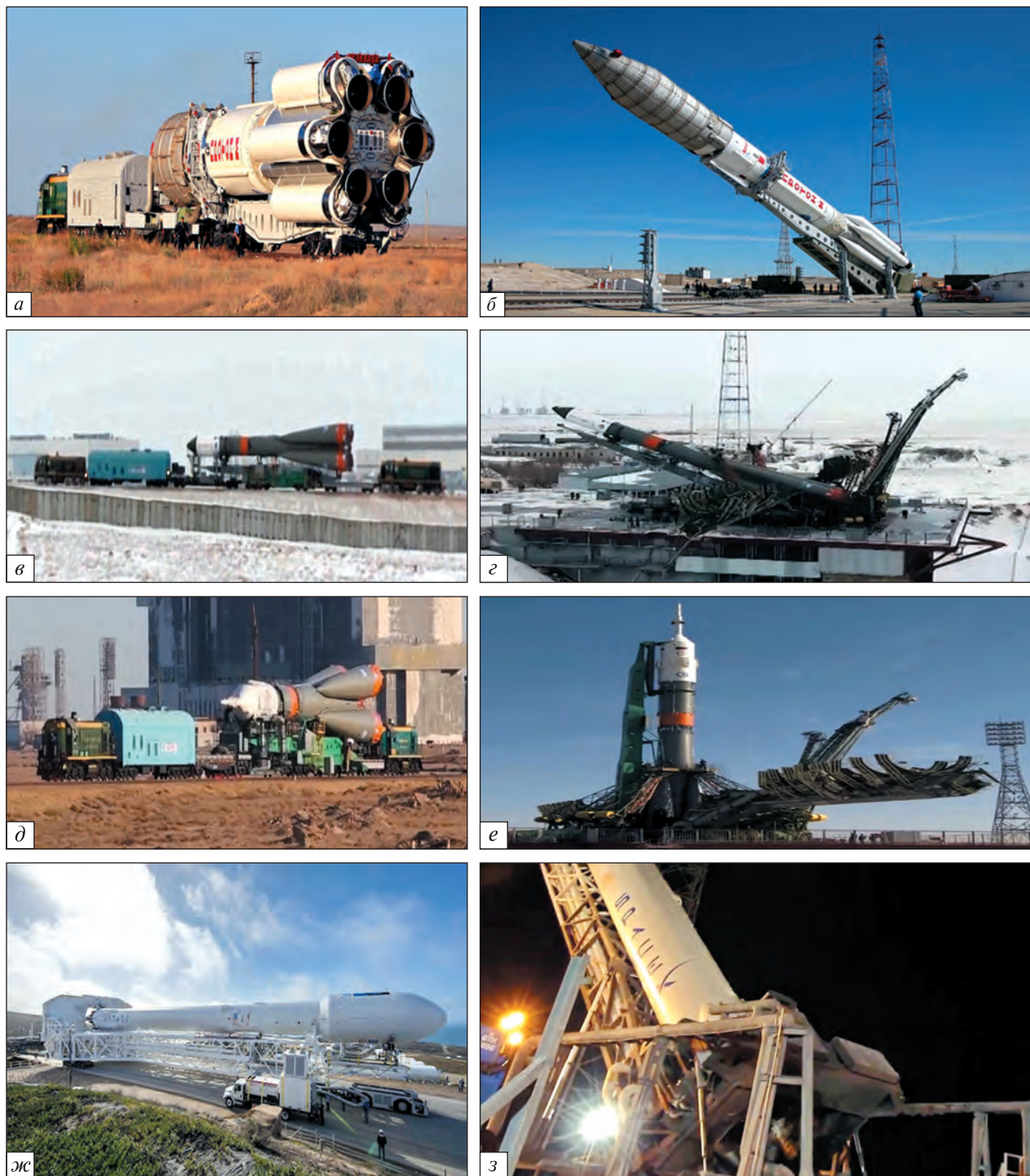
Рис. 1. Транспортно-установочный агрегат на железнодорожном ходу с использованием серийных колесных пар при транспортировании и установке ракеты космического назначения на пусковой стол: а, б — для РКН «Протон М», в, г — для РКН «Союз-У», д, е — для РКН «Союз-ФГ», ж, з — для РКН «SpaceX»
