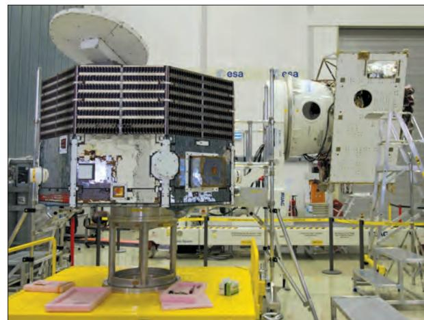
Рис. 6. Модулі ММО та МТМ (справа) у складальному цеху.
