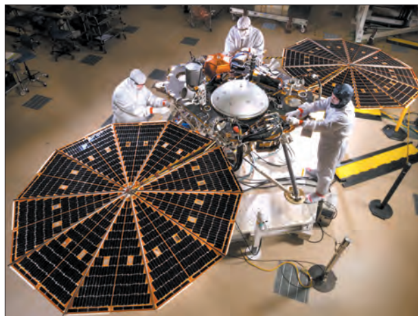
Рис. 11. «InSight» у чистій кімнаті цеху Lockheed Martin. Credit: NASA/JPL-Caltech/Lockheed Martin
