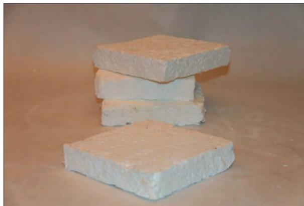
Рис. 2. Теплоизоляционные плиты высокотемпературной легкой теплоизоляции
