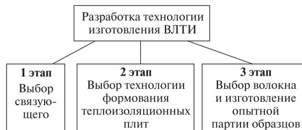
Рис. 1. Блок-схема разработки технологии изготовления высокотемпературной легкой теплоизоляции
