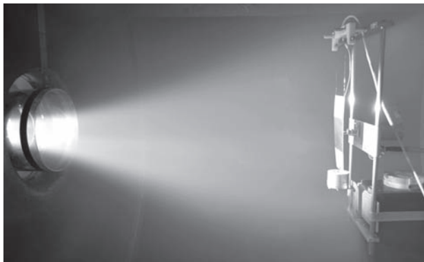
Рис. 7. Аэродинамические весы с образцом в потоке плазмы на стенде ИТМ
