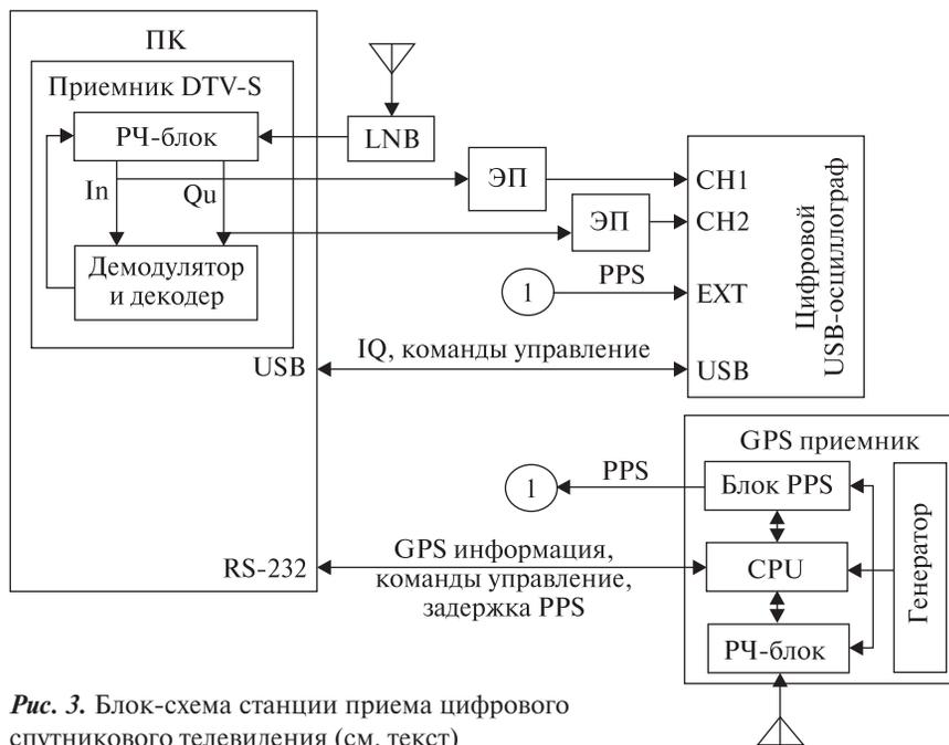
Рис. 3. Блок-схема станции приема цифрового спутникового телевидения (см. текст)
