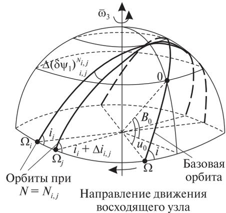
Рис. 5. Положение солнечно-синхронных орбит двух  $(i, j)$  спутников через  $N_{i,j}$  витков полета
