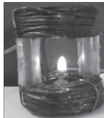
Рис. 2. Стеариновий циліндричний зразок, розміщений між котушками по типу кілець Гельмгольца, що створюють постійне однорідне магнітне поле
